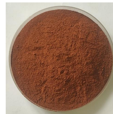
Figure 2: Poudre de latérite prête pour emploi
